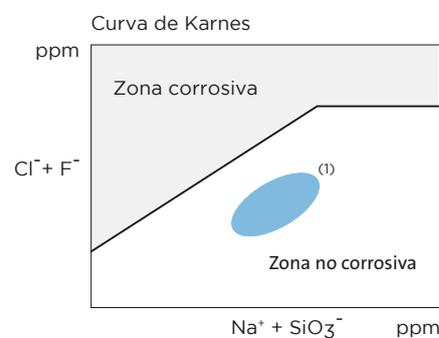
Nota: los análisis químicos de iones realizados según las normas ASTM C-795 y C-871 demuestran que los productos de Lana de Roca ISOVER no provocan la corrosión en el acero ya que la relación de iones  $Fl^- + Cl^-$  respecto a los  $Na^+ + SiO_3^-$  se sitúa en la parte inferior de la Curva de Karnes.
